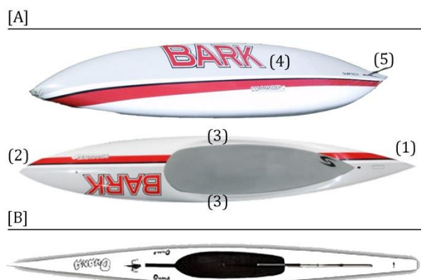
Ilustración 1. Diferentes tipos de tabla de Paddleboard. [A]: Surfttech Bark Board Coammander Pro Elite Red 12'0, con la presencia de (1) Popa, (2) Proa, punta, (3) Railes, (4) Parte inferior y (5) Quilla. [B]: Modelo Paintrest "19ft Board", Clase Unlimited ±17ft.
